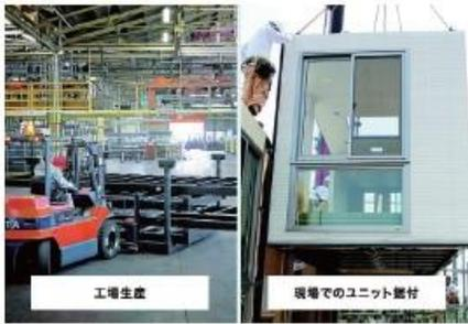
自動車の生産を通じて培われてきたトヨタの基本思想が住宅づくりにも活かされています。トヨタホームの家は85%が工場生産、システム化された生産工程、充実した人材育成プログラム、500項目におよぶ検査体制。一つひとつのプロセスの積み重ねによって、パツキのない安定した家づくりをしています。
